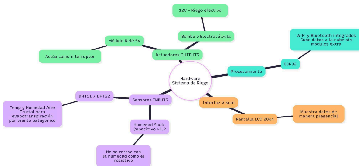
Figura 2. Mapa conceptual de la arquitectura de hardware y componentes del sistema.
