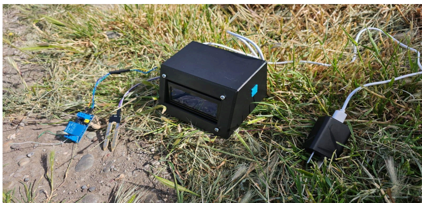
Figura 4. Prototipo del sistema de riego ensamblado en caja estanca para pruebas en exterior.
